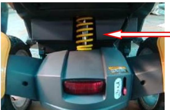
La fermeté de la suspension arrière est réglable. Il y a 5 niveaux d'ajustement. La capacité du système est d'environ 120 kg et chacun des niveaux peut porter jusqu'à 13,5 kg.
